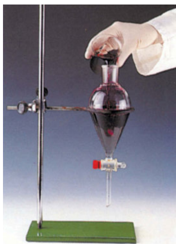
Fig. 1.23 Imbuto separatore costituito da un'ampolla che termina in una cannula alla cui estremità inferiore è posto un rubinetto per la regolazione del flusso in uscita.
