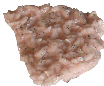
Fig. 1.13 Campione di dolomite (il nome viene da Dieudonné Dolomieu, 1750-1801, geologo e mineralogista francese che per primo descrisse il minerale).
