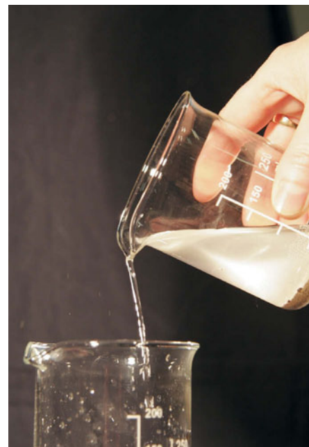
Fig. 1.19 Tecnica della decantazione.
