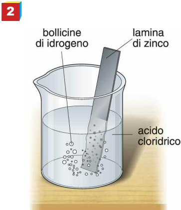
Fig. 2. Se si immerge una lamina di zinco in una soluzione acquosa contenente acido cloridrico, si osserva che lo zinco si corrode, mentre si sviluppano bollicine di idrogeno: ciò avviene perché lo zinco prende il posto dell'idrogeno, presente nell'acido cloridrico e forma il cloruro di zinco ( \text{ZnCl}_2 ), un sale solubile in acqua, mentre l'idrogeno si libera nell'aria come molecola biatomica ( \text{H}_2 ).
